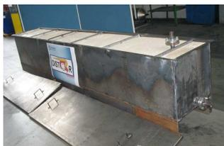
Módulo prototipo de almacenamiento térmico a base de PCM, de 200 kWh
