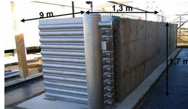
Módulo prototipo de almacenamiento térmico a base de hormigón, de 400 kWh
