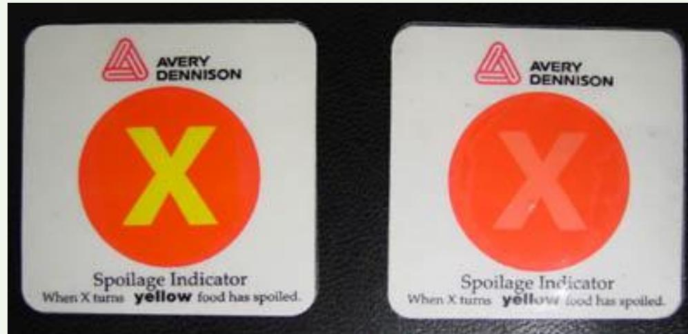
Complejo con Pd que reacciona con volátiles que contienen compuestos con S ó N. Al reaccionar el complejo induce un cambio de ligando y crea una fluorescencia provocando un cambio de color de la etiqueta de rosa a amarillo
