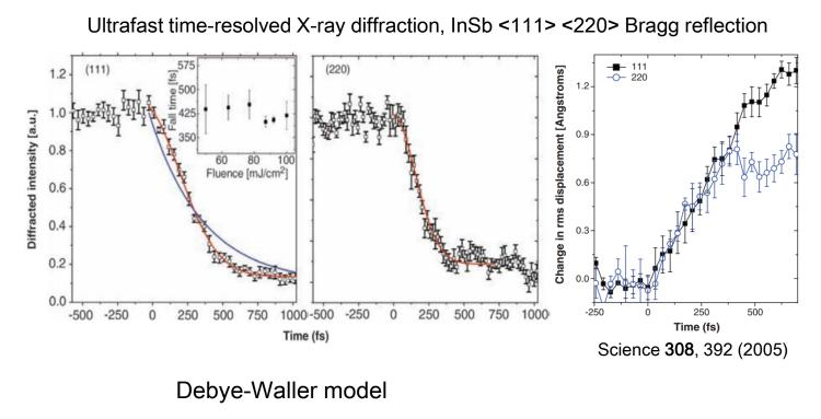
$$I(Q, t) = e^{-2W} = e^{-Q^2 < u^2(t) > /3} \sim e^{-Q^2 v_{rms}^2 t^2 / 3}$$
