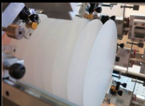
Testaufbau des MADMAX-Experiments: Der Photonenanteil der Axionen erzeugt beim Übergang von Luft zum Material der Scheiben Radiowellen, die sich messen lassen. (Foto: MADMAX Collaboration)
